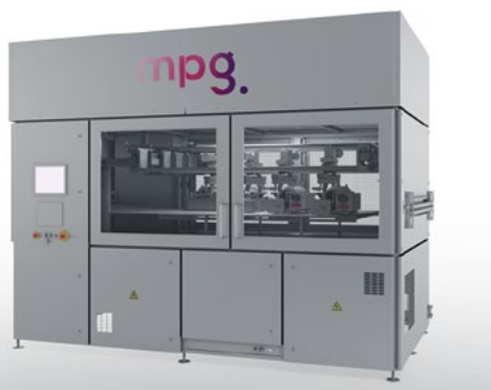
Bild 2: PlasmaLine® 1600 mm – für die Vorbehandlung großer Flächen (Bild: Molecular Plasma Group)
